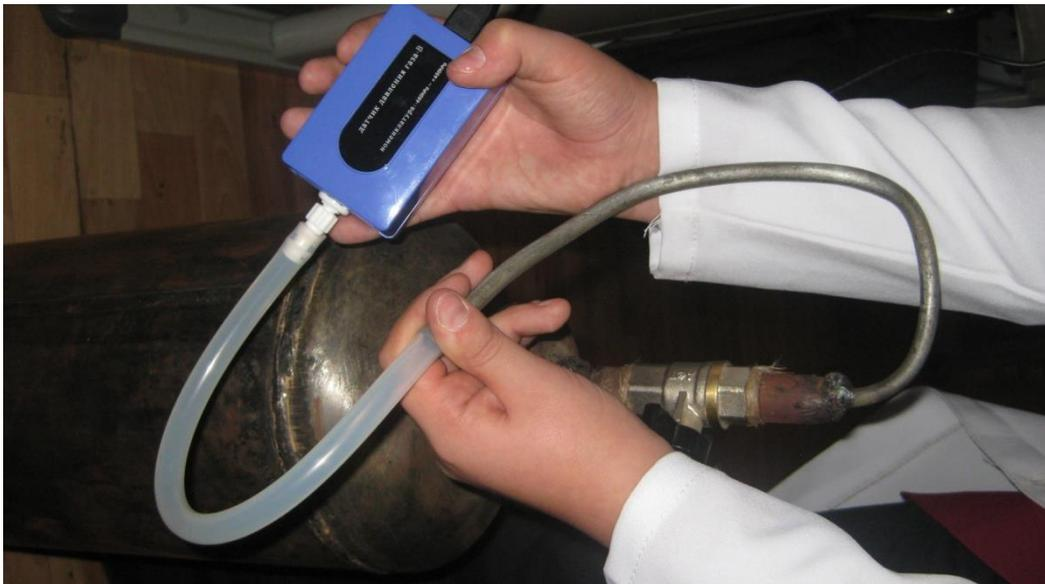
Рис. 2. Подключение биореактора к датчику через трубку
