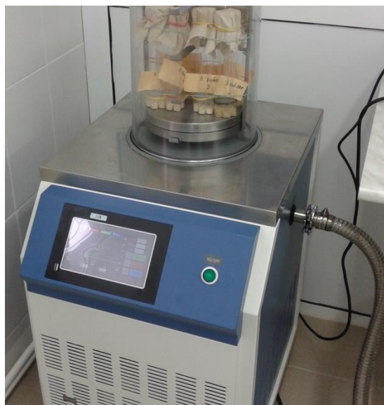
Рисунок 2 - Установка лиофильной сушки в процессе работы
