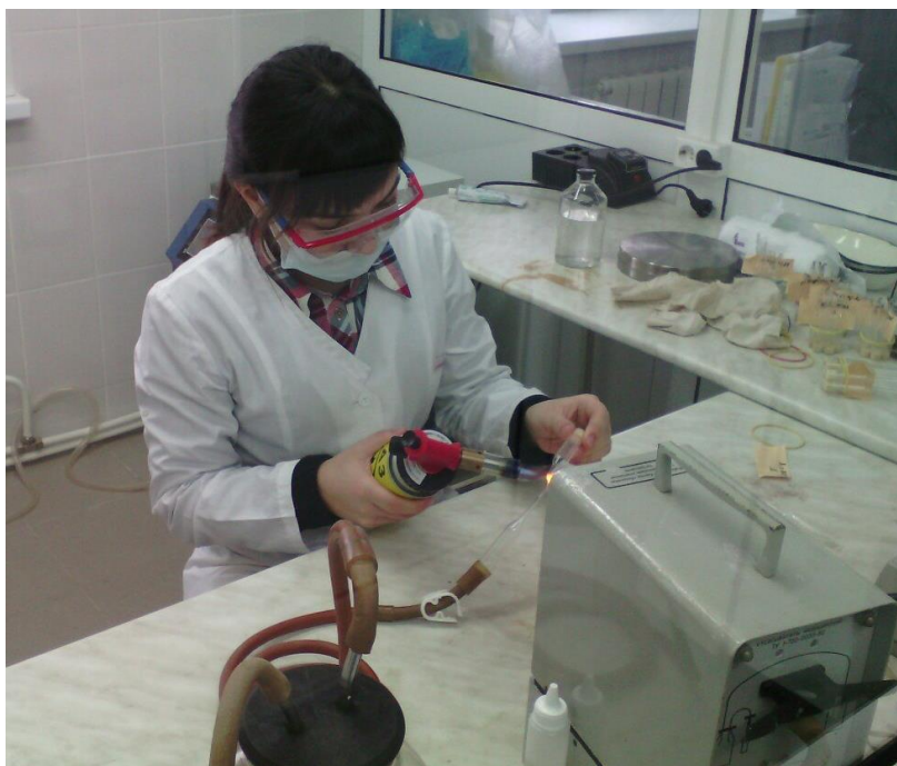
Рисунок 3 - Процесс запаивания ампул под вакуумом
