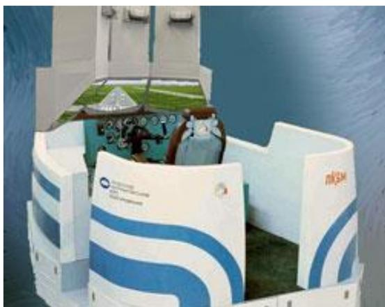
Рис.1 – Внешний вид пилотажного тренажёра лётчика без подвижности с трёхканальным устройством безочкового моделирования трёхмерного визуального наблюдаемого пространства для одного лётчика
