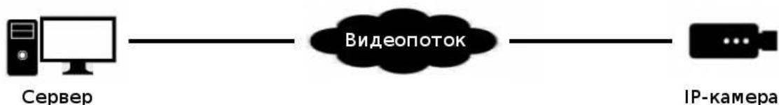
Недостатками такой схемы будут, высокая нагрузка на сеть, высокая стоимость сервера, даже к самому мощному серверу можно подключить ограниченное количество IP-камер, т.е. чем больше система тем больше серверов.
