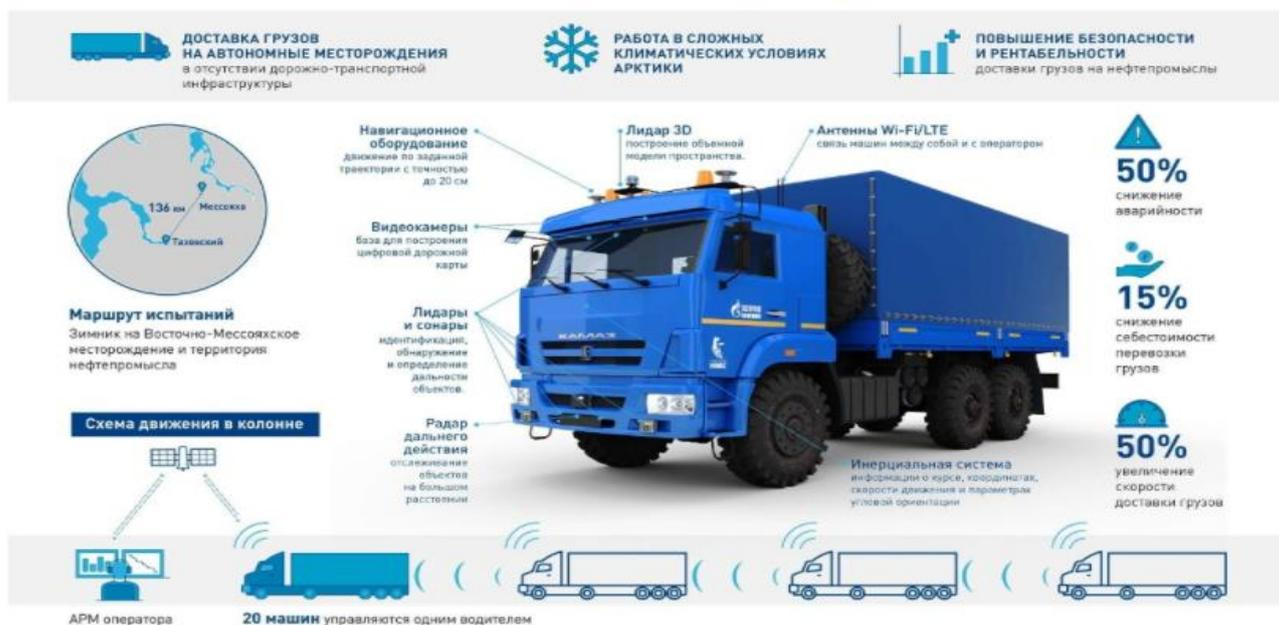
Рис.1 Итоги испытаний беспилотных КАМАЗов на Восточно-Мессояхском месторождении.
