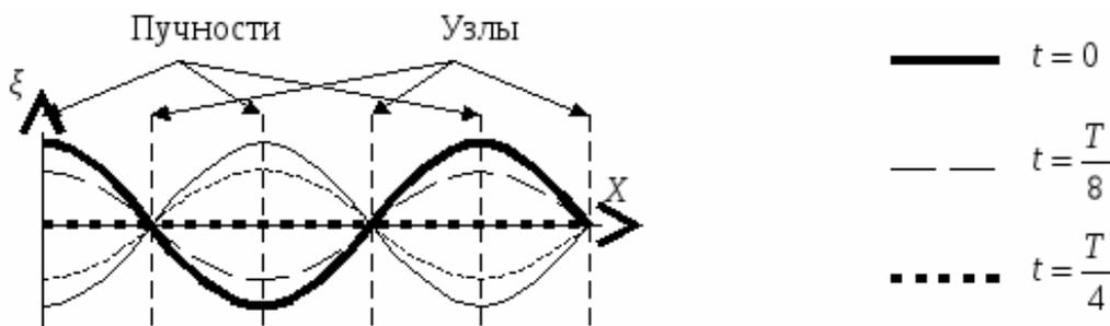
Рисунок 2. Поведение акустической цепочки системы осцилляторов в звуковом поле стоячих волн [4]
