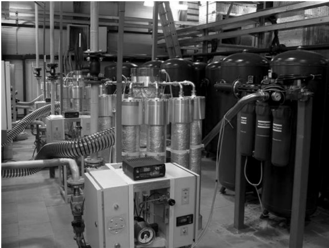
Рисунок 2. Азотная мембранная установка
