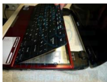
Рисунок 9 – Извлечение клавиатуры из корпуса нетбука
