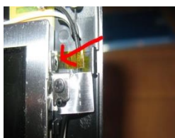
Рисунок 5 – Крепления на боковых поверхностях матрицы
