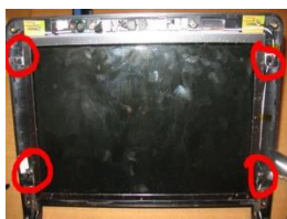
Рисунок 4 – Крепления матрицы к корпусу
