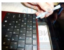
Рисунок 8 – Демонтаж клавиатуры нетбука
